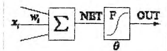
Рис. 3. Загальний вигляд схеми перцептрона з одним нейроном та суматором на вході
