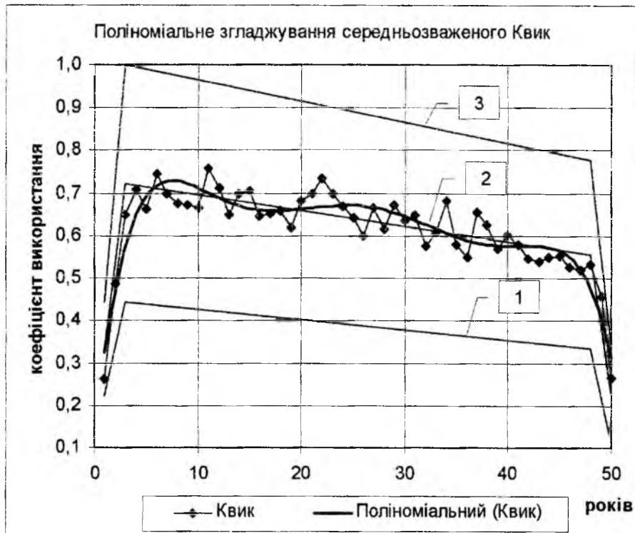
Рис. 1. Результати моделювання потужностей (паспортної, встановленої, фактичної) шахти через коефіцієнт її використання. 1 – нижня границя інтервалу розсіювання; 3 – верхня границя інтервалу розсіювання, 2 – середина інтервалу розсіювання.
