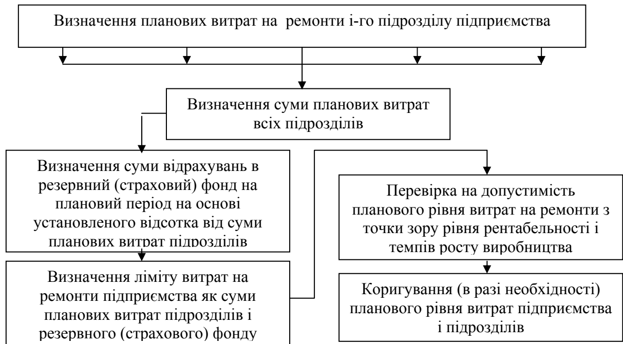
Рис.4 . Структурна схема порядку планування витрат на ремонти на основі витрат підрозділів
