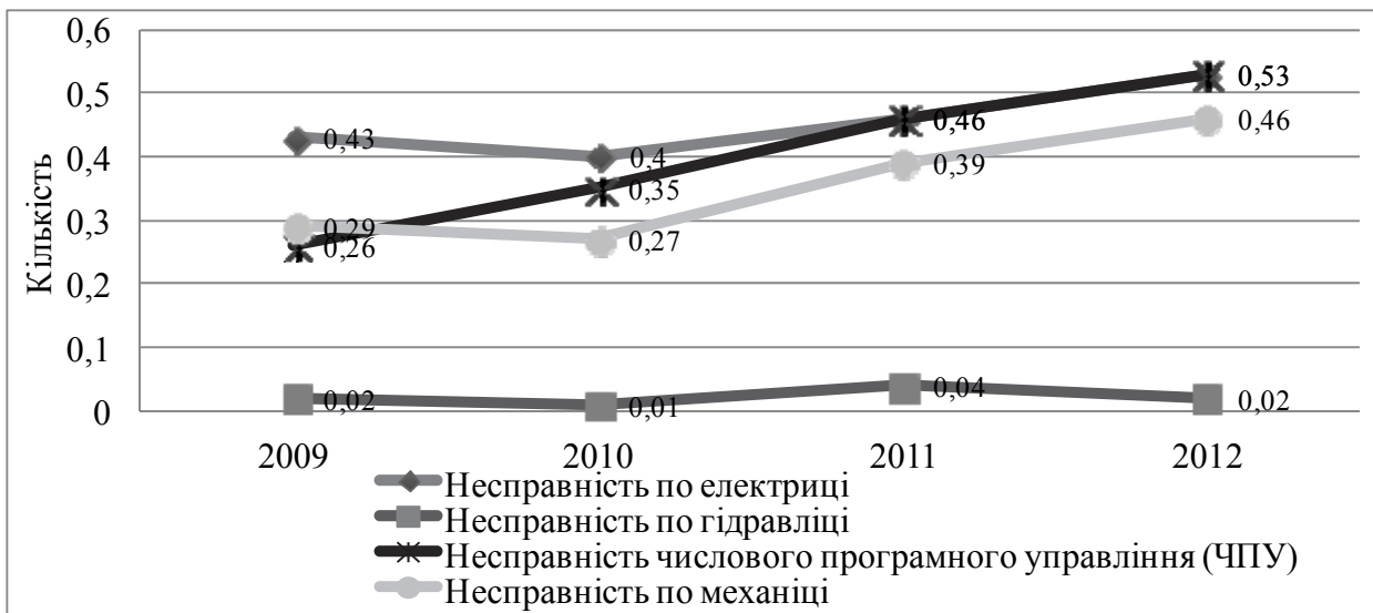
Рис. 10. Відносна величина аварійного простою по видам несправності устаткування у ПАТ «Дніпропетровський агрегатний завод»
